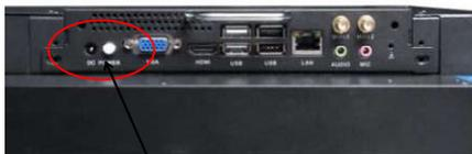
机器内置电脑的电源开关机
